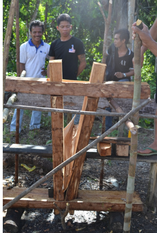
Gambar 2. Alat apit untuk mengeluarkan minyak dari bubuk tengkawang yang sudah dikukus terlebih dahulu. Foto oleh Alfa Ratu Simarangkir (2013)
