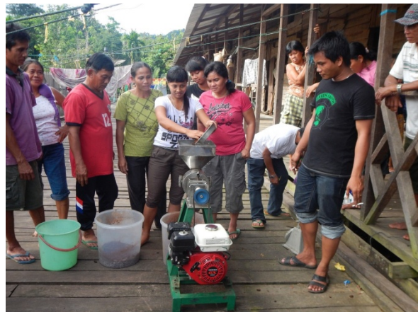
Gambar 4. Alat penghancur buah tengkawang yang sudah dikukus sehingga menjadi bubuk tengkawang
