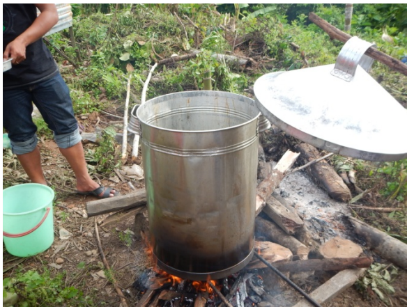
Gambar 3. Alat pengukus buah tengkawang
