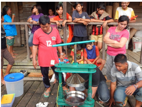
Gambar 5. Alat pres bubuk tengkawang yang berfungsi untuk mengeluarkan minyak dari bubuk tengkawang
